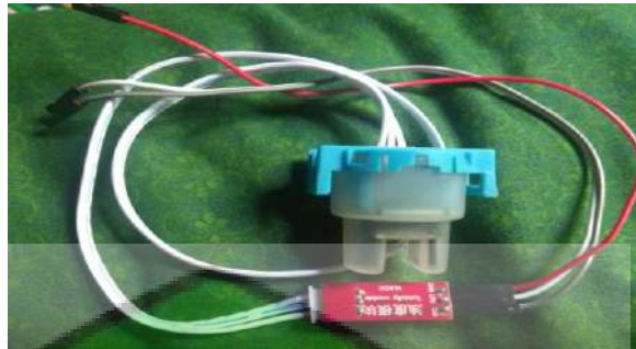
Gambar 3.8 Pemasangan Kabel Ke Modul Sensor Ntu
